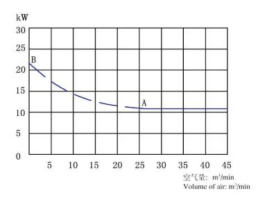
注: A实线段为曝气功率, B虚线段为搅拌功率, 工况: 大气: 1.012bar、20℃、1.2kg/m3 水温: 10℃
